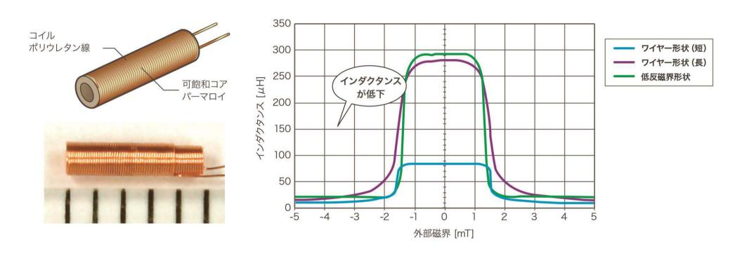
[非飽和状態と飽和状態におけるインクダンスの差が大きく、その変化も急峻] 増幅器なしでも数mTの磁界に対して数Vのアナログ電圧が検出できます
